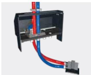
Die Sondenwahl für 4 bzw. 8 Absaugsonden erfolgt automatisch in festgelegten Zyklen, die Steuerung erfolgt durch den Pelletskessel. Sollte es dennoch zu einer unerwarteten Störung an der Absaugsonde kommen, so wird durch eine **vollautomatische Umkehr der Luftführung (Rückspülung)** diese wieder behoben.
